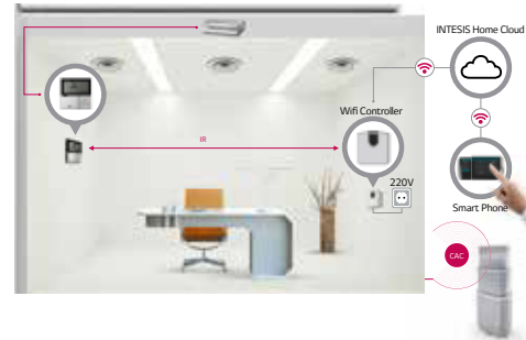
2) Verbindung mit Kanaleinbaugeräten
