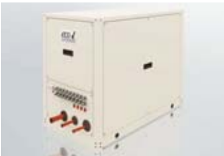
Die Kältemittel-Sammelstation von Panasonic ist schnell und einfach zu installieren. Das in Schutzart IP54 ausgelegte Gehäuse der Sammelstation enthält 5 Kugelventile mit Stellglied, einen 30-l-Kältemittelsammler und die zugehörige Steuerung. Die Klemmen für den Störmelde-Ausgang, die Hochdruck- und Niederdruck-Messwertgeber und die Heißgastemperaturfühler der Außengeräte befinden sich an der Frontseite der Sammelstation, um das Anschließen zu erleichtern.
